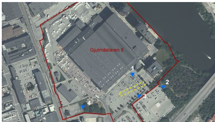
Bergrummets ungefärliga placering på Gjutmästaren 6. Blåa markeringar är grundvattenrörens mätplatser av förändringar i grundvattennivåer.
